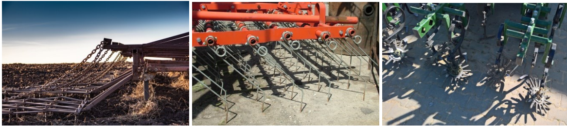
Sika 5.17. Drljače za suzbijanje korova: lančana drljača (lijevo – https://www.shutterstock.com ), tanka pljevilica (sredina – I. Tirczka), pljevilica u obliku prsta (desno – I. Tirczka)
