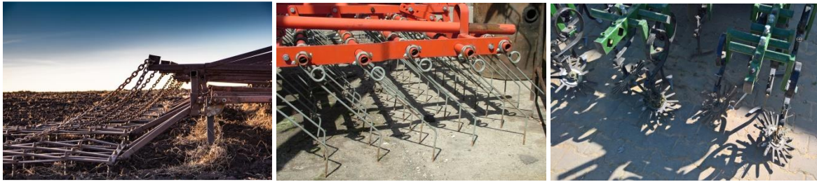
5.17. ábra. Gépek a gyomirtásban: láncos borona (balra - https://www.shutterstock.com ), fésűs borona (középen – I. Tirczka), ujjas kapa (jobbra – I. Tirczka).
