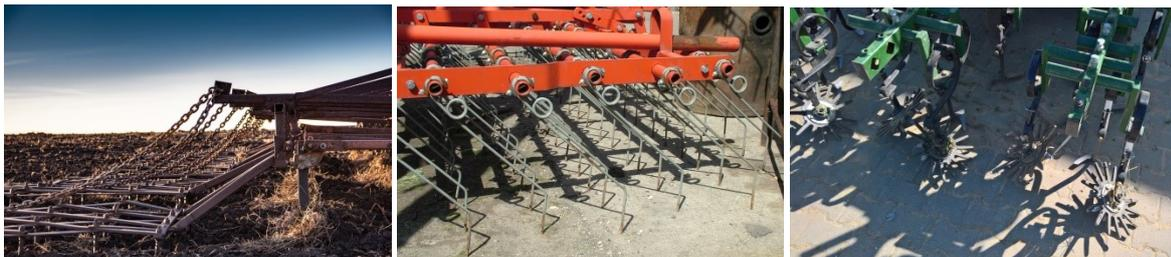
**Abbildung 5.17** Eggen für die Unkrautbekämpfung: Kettenegge (links -
