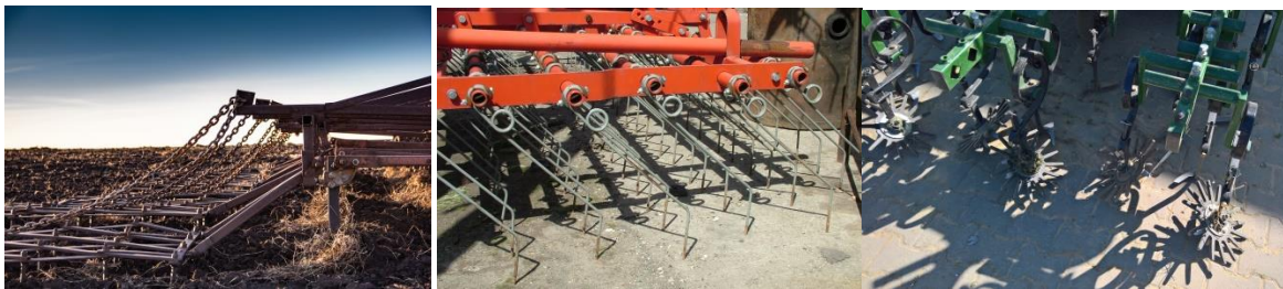
Slika 5.5 Brane pri ravnanju s plevelom: verižna brana (levo - ( https://www.shutterstock.com ), zobate brane (sredina - I. Tirczka), prstne brane (desno - I. Tirczka)
